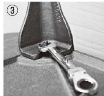
脚部を全ネジボルトに差し込み、ストープ本体の底面の角の内側に押し当てた状態で全ネジボルトをマイナスドライバーでナットがあたるまで締めます。最後にスパナでナットを本締めしてください。
