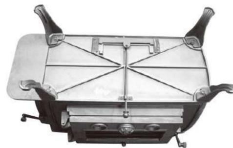
4. 煙突受けをストープ本体に皿頭ボルトセットで取り付けます。
