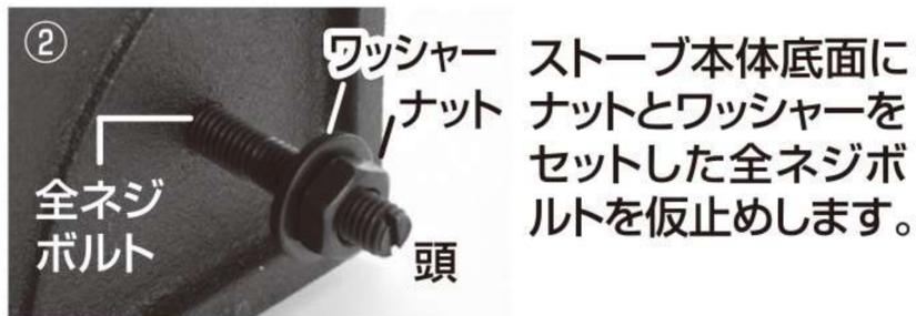
ストーブ本体底面にナットとワッシャーをセットした全ネジボルトを仮止めします。
