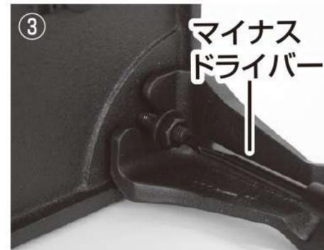
脚部を全ネジボルトに差し込み、ストーブ本体の底面の角の内側に押し当てた状態で全ネジボルトをマイナスドライバーでナットがあたるまで締めます。
