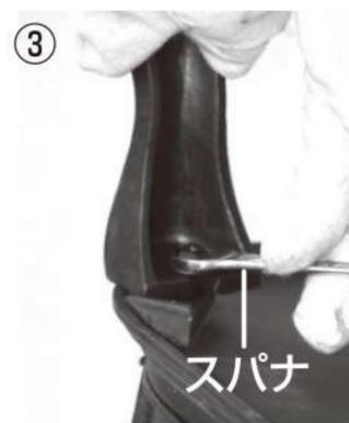
脚部を全ネジボルトに差し込み、ストープ本体の底面の角の内側に押し当てた状態で全ネジボルトをマイナスドライバーでナットがあたるまで締めます。
