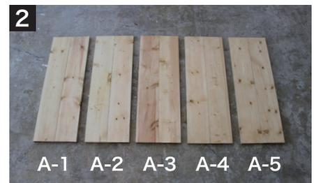
同様に残りの木材もなみ釘を打込み連結させる。写真のように A-1~A-5 の 5 枚の木材を用意する。
