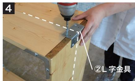
ラックの底に外側から L 字金具で固定する。木材の連結部分 (中心) をまたぐように固定。反対側も同様に固定する。
