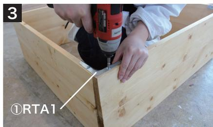
完成図で組み方を確認し A-1~A-4 の 4 枚を RTA1 で口の字になるよう固定する (表裏 4 カ所)
