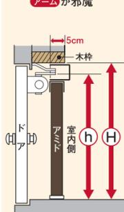
木枠までの寸法(H)とアームだけが邪魔な時は、アーム下までの寸法(h)を測ります。
