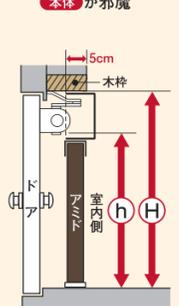
木枠までの寸法(H)と、ドアクローザー本体が邪魔な時は、その下までの寸法(h)を測ります。
