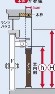
ランマ枠までの寸法(H)と、ドアクローザー本体が邪魔な時は、その下までの寸法(h)を測ります。
