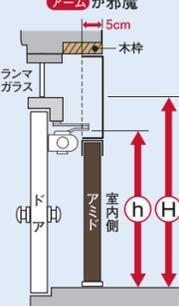
ランマ枠までの寸法(H)と、アームだけが邪魔な時は、アーム下までの寸法(h)を測ります。
