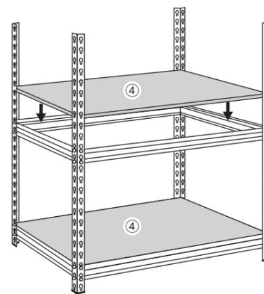
**4** 組み立てた棚の上から、さらに①支柱を4本⑥支柱連結金具で連結させ、支柱の上端に⑤支柱保護カバーを取り付けてしっかりと固定させます。その後、**2**から**3**の順番で組立を行います。※一つずつ、ゴムハンマーで軽く叩いて、しっかりと連結します。
