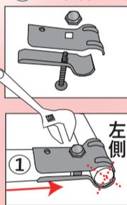
⑥を軽めにバラし、奥行ベースパイプの小口に合わせます。①を差込みナットを締め固定します。
