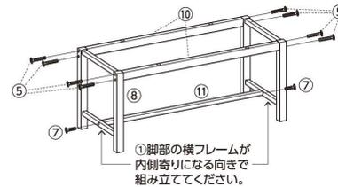
**4** ③の組み立て品に⑥ボルト(中)を使って、⑨座面を仮締めして連結してください。
