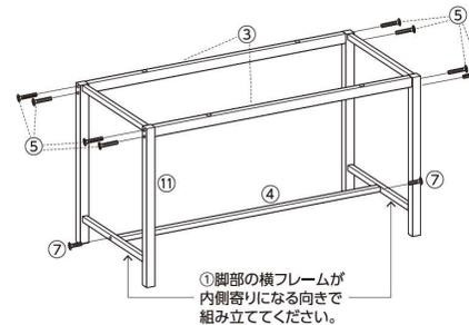
**2** ①の組み立て品に⑥ボルト(中)を使って、②天板を仮締めして連結してください。
