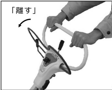
⑥作業を終了する場合には、まず主クラッチレバーから手を離し、本機を停止させてください。(遠心クラッチが切れ、ナイフの回転と走行が停止します。)
