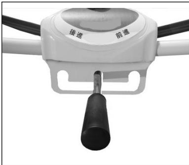
②正逆レバーを操作し、左右の切欠き位置に確実に入れ替えてください。
