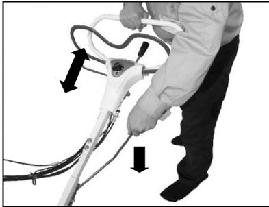
作業条件に合わせてハンドルの長さを15cmの間隔の4段階で固定できます。傾斜面の長さに応じて使い分けてください。
