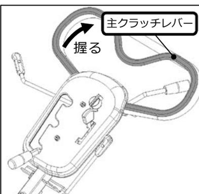
⑥ 主クラッチレバーを徐々にハンドル側に引いていくと、エンジン回転が上昇し、遠心クラッチによりナイフが回転を始めます。
