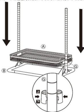
⚠ 1段目のAバスケットは、ボールのスリットの最下段に取り付けてください。
