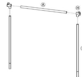
6 ⑥サイドバーに①キャップを取り付け、⑤で取り付けた⑧ジョイントに差し込みます。
