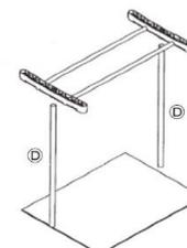
4 ④中太パイプに⑧ジョイントを差し込み、②太パイプに取り付けます。
