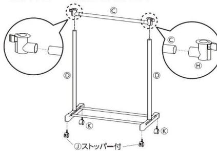
5 ①太パイプに⑧ジョイントを差し込み、④中太パイプを取り付けます。
