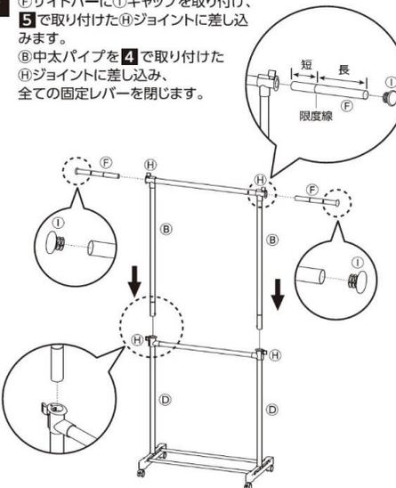
7 ハンガーの高さ、幅を調節する際は、⑧ジョイントの固定レバーを開いて調節し、固定する際はストッパーを閉じてください。グラつきやガタつきがない事、各ジョイントの固定レバーがしっかりしまっている事を確認してから使用してください。
