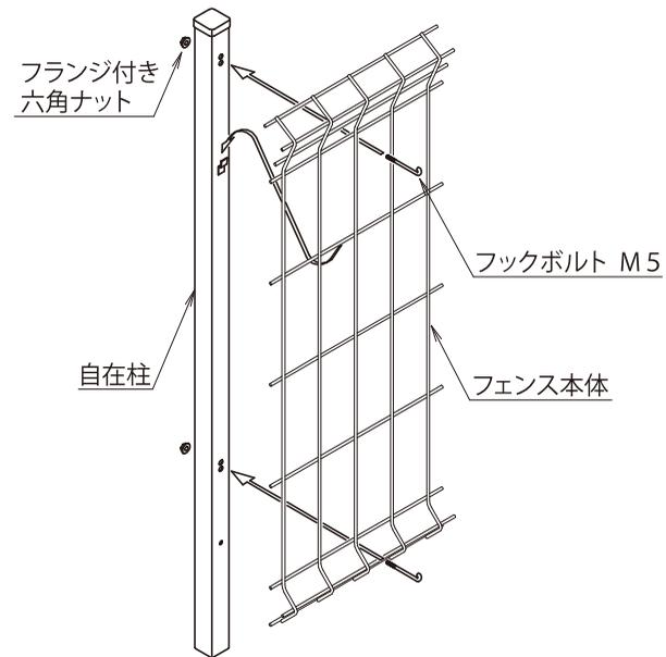
フェンス本体を自在柱の中間受け金具に引っかけて、フックボルトとフレンジ付きナットでフェンス本体と自在柱を締結します。
