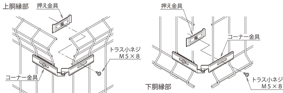
コーナー部は、上胴縁の下側と下胴縁の上側をコーナー金具と押え金具でジョイントします。
